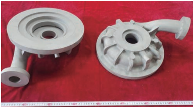
图 14 中国科学院金属研究所研制的 GH4169 粉末冶金构件 Fig.14 GH4169 powder metallurgy component by IMR, CAS
