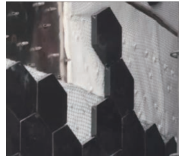
(b) 机械连接式热防护瓦 [24]
