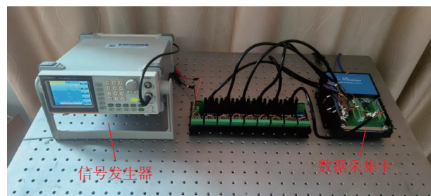
图 8 多测头同步精度测量试验现场图
